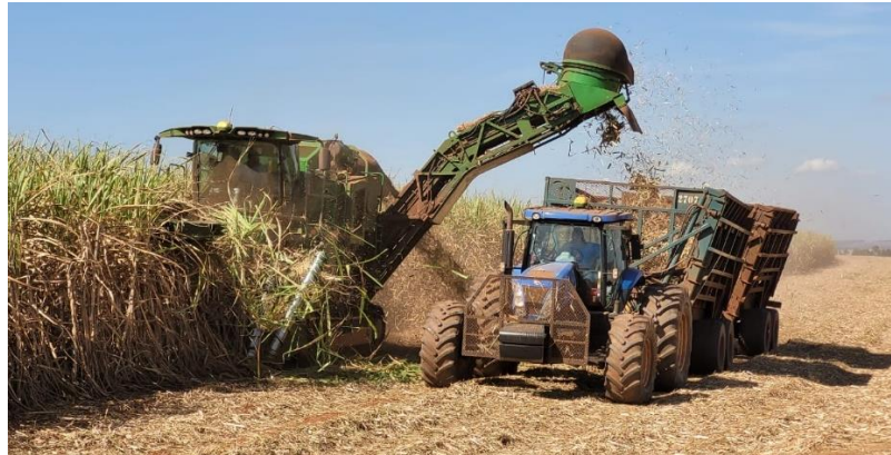
Figura 4 – Processo de colheita da cana-de-açúcar (cortadora-fatiadora ao lado de um caminhão de transbordo)
