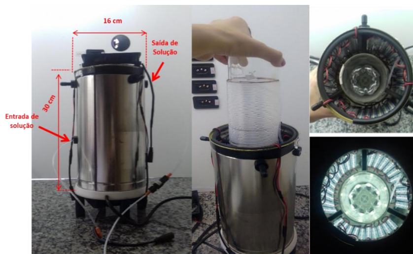
FIGURA 10: Reator fotoquímico em tubo de PFA (1/8 in, O.D), construído em nosso laboratório.
