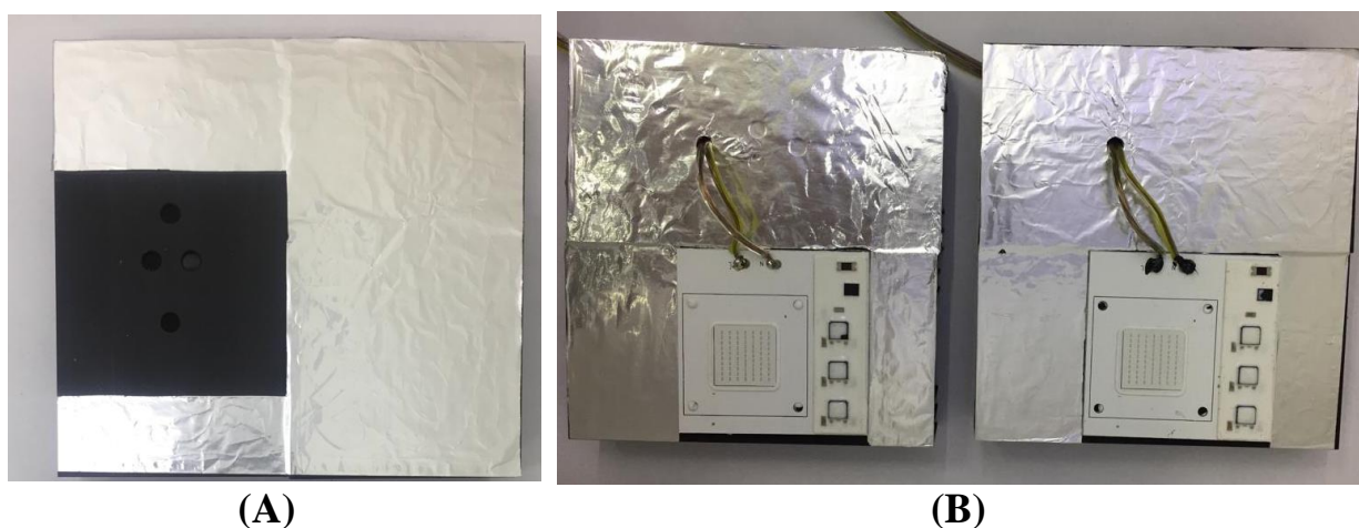
FIGURA 12: (A) Recobrimento da placa dissipadora de calor com papel alumínio. (B) Colagem dos chips e soldagem dos fios nos terminais eletrônicos.
