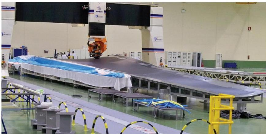
Figura 11 - Fabricação dos cascos da asa inferior do A350 (parte do esqueleto) [25].
