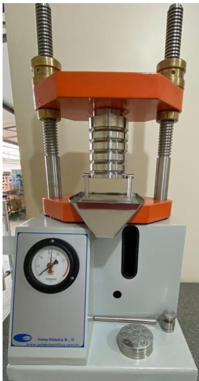
FIGURA 4.2.6. Visão geral da prensa hidráulica SL-10 da Solab.
