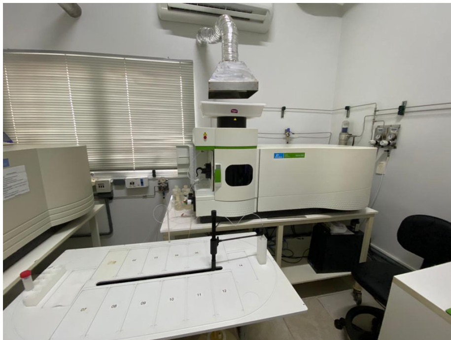
FIGURA 4.2.4. Visão geral do ICP OES Optima 8300 da PerkinElmer acoplado ao auto amostrador SC-14 da ESI.
