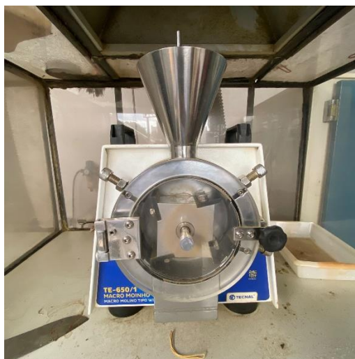
FIGURA 4.2.2. Visão geral do moinho tipo Willey TE-650/1 da Tecnal.
