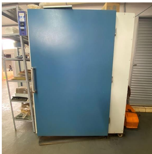
FIGURA 4.2.1. Visão geral da estufa TE-394/5 da Tecnal.
