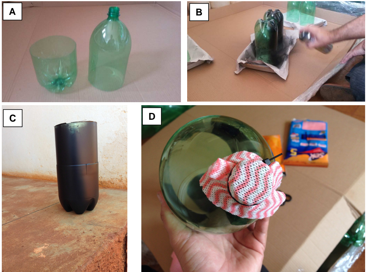
Figura 7. Construção dos vasos de Leonard (Sorreano, 2006): a) garrafa PET transparente de 3 L cortada ao meio; b) aplicação de tinta preta no exterior da garrafa PET; c) vaso de Leonard pintado; d) fixação do perfex no bocal da garrafa da PET.
