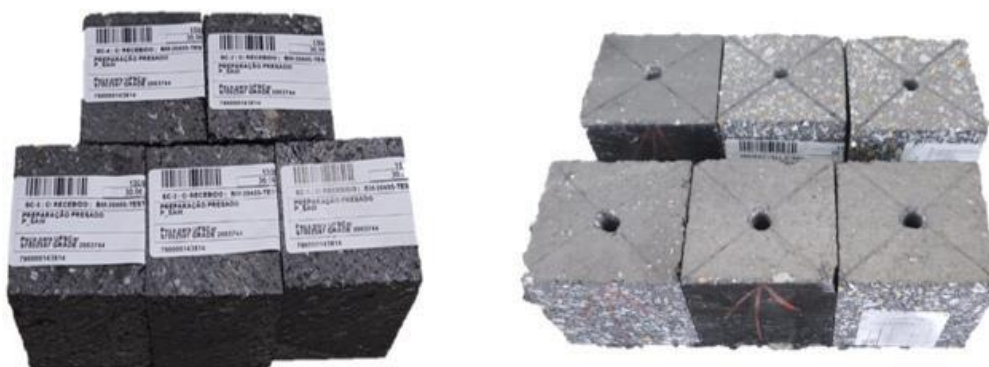
Figura 11 — Amostras de mesma composição e dimensões recebidas no laboratório GEMM para realização de 2ª (esquerda) e 3ª (direita) baterias de testes de cura por micro-ondas
