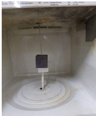
Figura 28 — Modificações de alocação do termopar e suporte de amostras para orifícios superior e inferior, respectivamente, do sistema para análise de cura por micro-ondas
