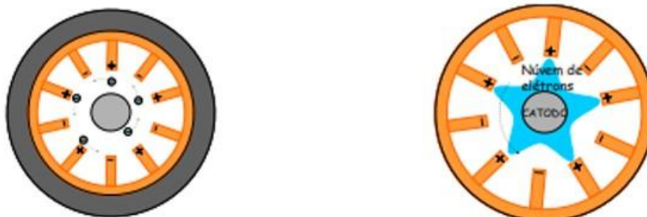
Figura 3 — Representação esquemática de corte transversal de um magnetron para ilustrar processo de formação de micro-ondas eletromagnéticas
