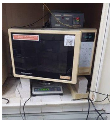
Figura 29 — Alocação do sistema de análise de cura por micro-ondas em capela de exaustão devido a eliminação de componentes tóxicos provenientes da resina fenólica durante processo de cura por micro-ondas
