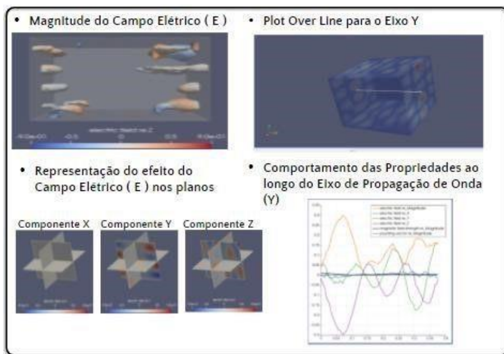
Figura 20 — Visualizações de pós-processamento de simulação de ondas eletromagnéticas no interior de uma cavidade de micro-ondas geradas por software Paraview
