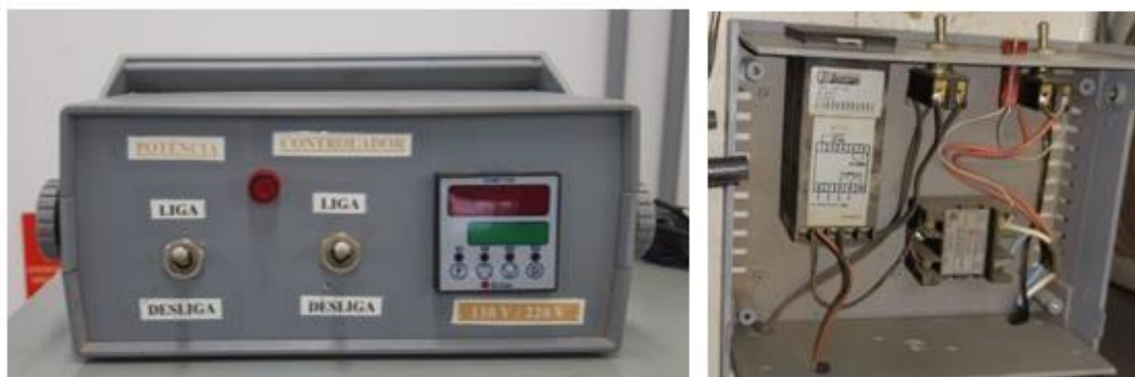
Figura 16 — Face frontal externa (esquerda) e interna (direita) de controlador PID utilizado no sistema de análise de materiais refratários contendo ou não fontes de carbono por micro-ondas
