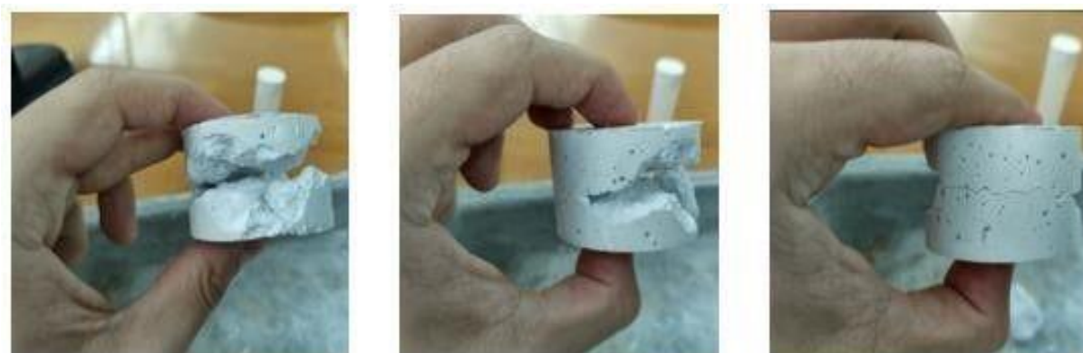
Figura 23 — Reconstituição de amostra com composição de 5CAC utilizada para 1º procedimento experimental de análise de cura por micro-ondas após realização de 1º teste
