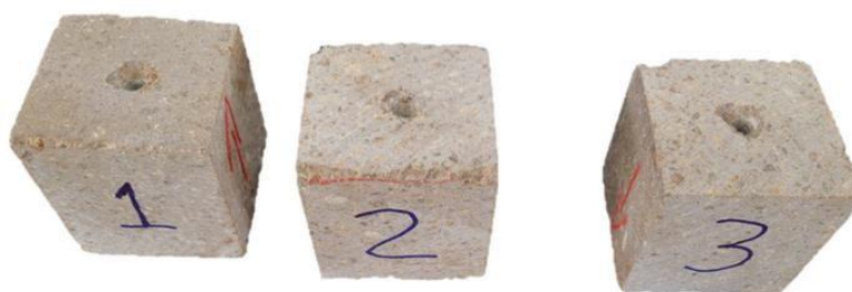
Figura 12 — Amostras contendo apenas MgO e resina fenólica recebidas para realização de 4ª bateria de testes
