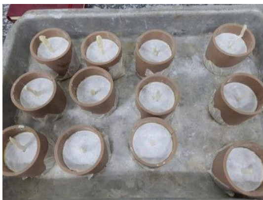
Figura 10 — Amostras para 1º procedimento experimental após processo de cura em estufa térmica
