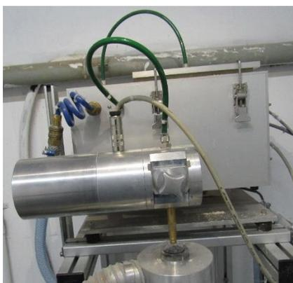
Figura 33 - Fotômetro, medidores de pressão e suporte de meio filtrante
