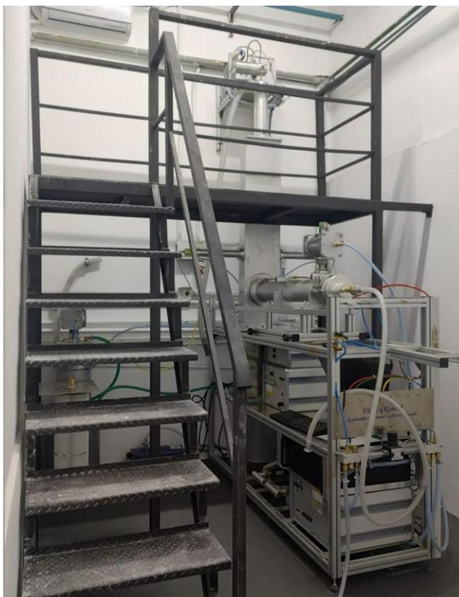
Figura 32 – Alimentador e dispersor de material particulado
