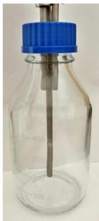
Em seguida, esse gás misturado é direcionado para o suporte central mostrado na Figura 42, que conta com uma sonda de aço inox que direciona o gás para o recipiente de vidro, esse gás passa através do meio filtrante com *precoating* que fica na parte central do suporte. E em seguida, é captado por outra sonda de inox que o direciona para um lavador de gases que, já limpo, é jogado no ambiente. O lavador de gases é aquecido à temperatura pré-determinada.
