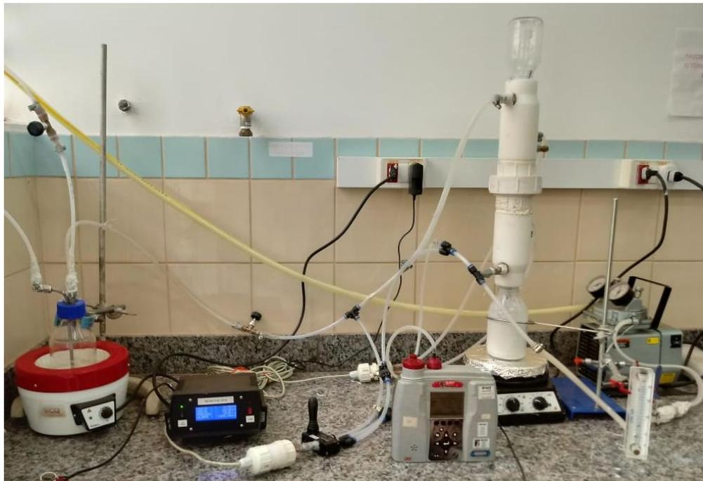
A unidade de dessulfurização, mostrada na Figura 40, é composta por um misturador de gases da Figura 41 com duas pequenas sondas de inox que alimentam o dióxido de enxofre (SO<sub>2</sub>) e o nitrogênio (N<sub>2</sub>) dos cilindros para o misturador e, uma sonda longa que direciona o gás misturado no suporte central. Aqui os gases são misturados e aquecidos à uma temperatura de 40°C.
