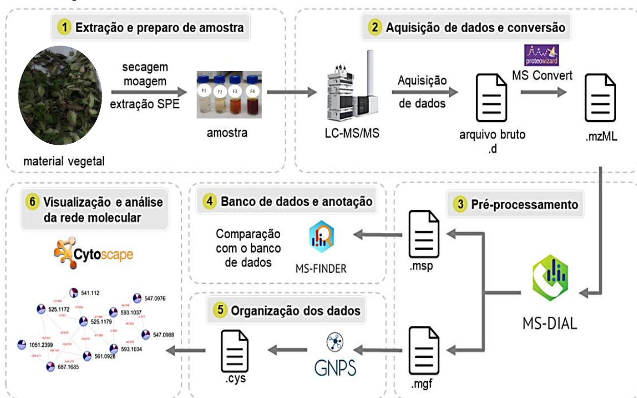
FIGURA 3.8 - Fluxograma exemplificando as etapas de processamento dos dados e visualização da rede molecular.
