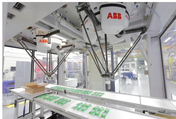
Figura 1 – Exemplo de robô paralelo industrial ABB Robotics (IRB 360).
