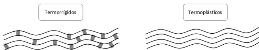
FIGURA 1.3: Diferença entre termorrígido e termoplástico.
