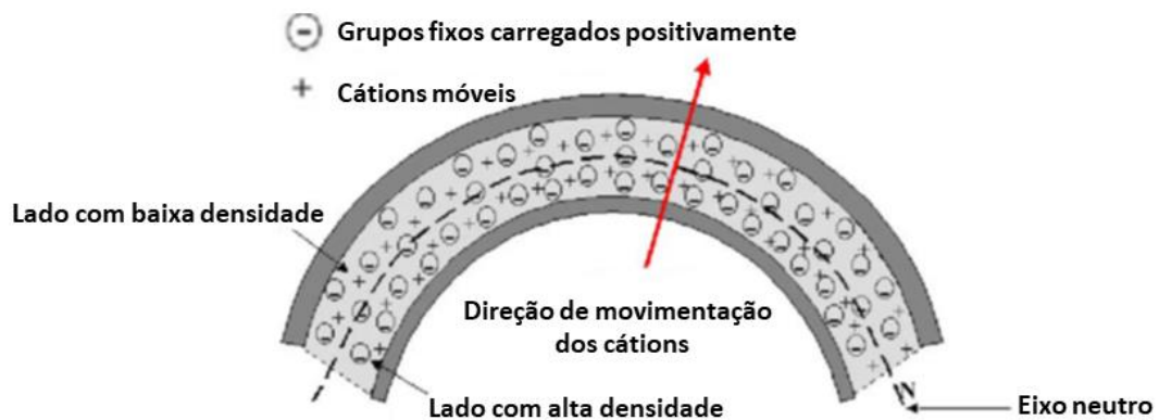
Figura 2.13 - Efeito da distribuição de carga com a aplicação de uma força externa no IPMC [130].
