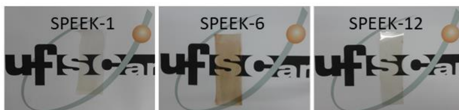
Figura 4.2 - Aspecto visual das membranas de SPEEK.
