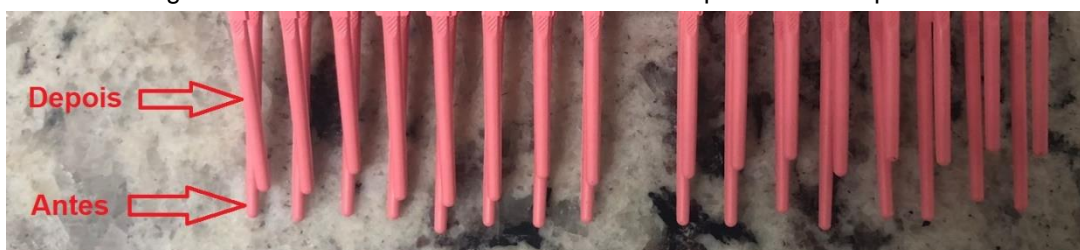
Figura 35 – Pentes Antes e Pós Tratamento Superficial Sobrepostos
