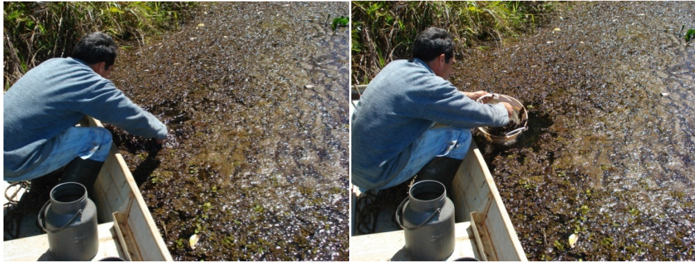
Figura 3: Vista de uma coleta da Salvinia utilizando puçá com área de 0,07 m 2 e malha de 0,25 mm.
