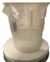
FIGURA 3. 7 – Preparação do gel de síntese do material mesoporoso MCM-41.
