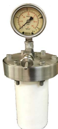
FIGURA 3. 6 – Reator de aço inox utilizado na síntese hidrotérmica.
