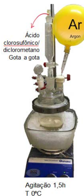
FIGURA 3. 13 – Esquema experimental montado para sulfonação do poli(éter sulfona) – SPES.
