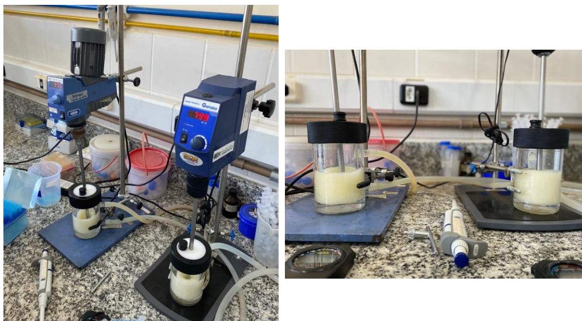
FIGURA 8. Experimentos 2 e 8 sendo realizados em reatores encamisados com agitadores
