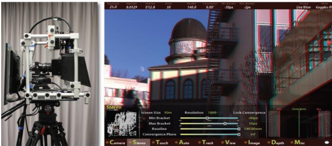
Fig. 34 - À direita, RIG especular implementado pela Disney Research, com câmeras montadas a noventa graus ante um semi-espelho; à esquerda, tela de monitoramento e controle do sistema (-Fonte: HEINZLE et al, 2011, p.1)
