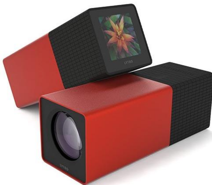
Fig. 35.- Câmera fotográfica Lytro. Mediante painel micro-lenticular fixado defronte ao sensor, captura imagens integrais em diversos planos focais, que podem ser traduzidas em estereogramas. (Fonte: < https://www.lytro.com/camera/ > Acessado em 20 set 2013).
