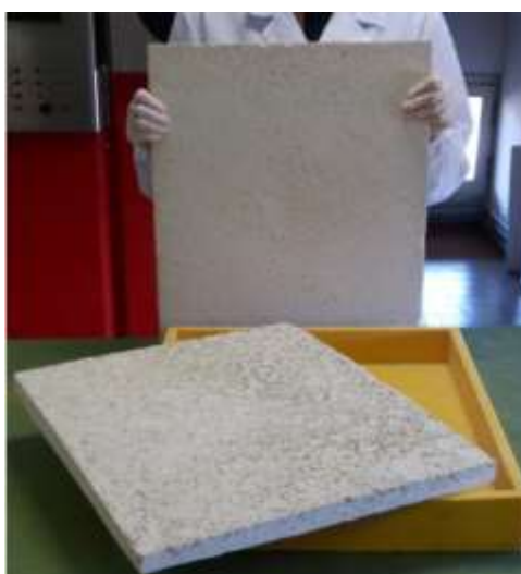
Figura 3.18 – Exemplo de painéis produzidos com agregado vermiculita após a desmoldagem [56].
