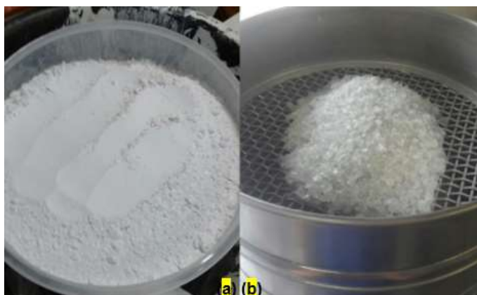
Figura 3.12 – Agregado vítreo: (a) forma em pó obtido por trituração; (b) forma em cacos obtido por moagem [44].
