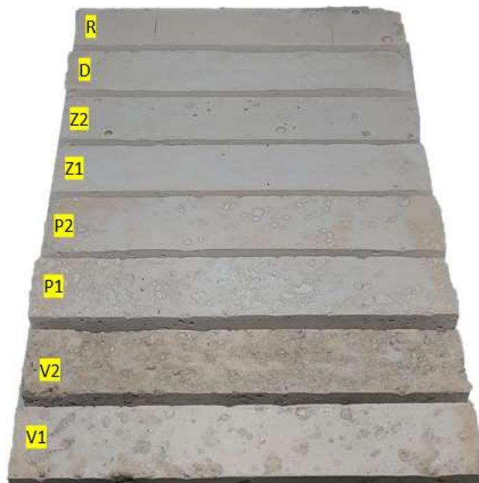
Figura 5.31 - Amostras após finalização do ensaio de envelhecimento acelerado por exposição UV.
