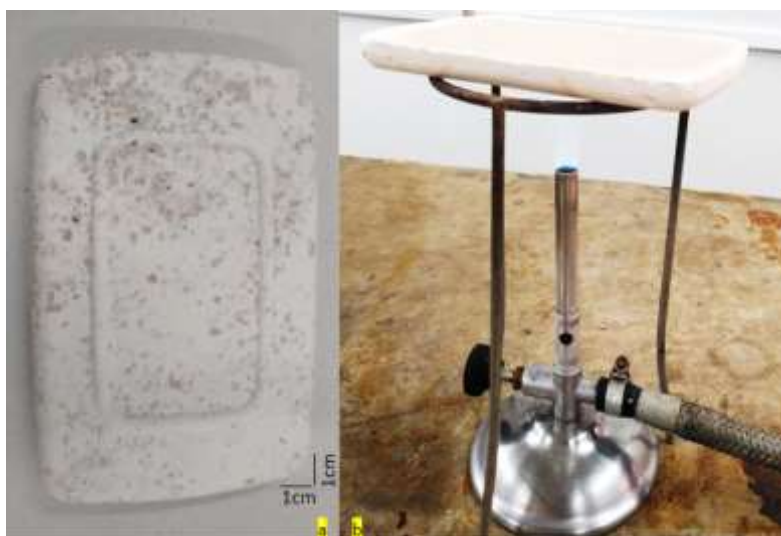
Figura 4.5 – Análise de ensaio de resistência ao fogo: (a) amostra antes do ensaio; (b) estrutura de ensaio de resistência ao fogo
