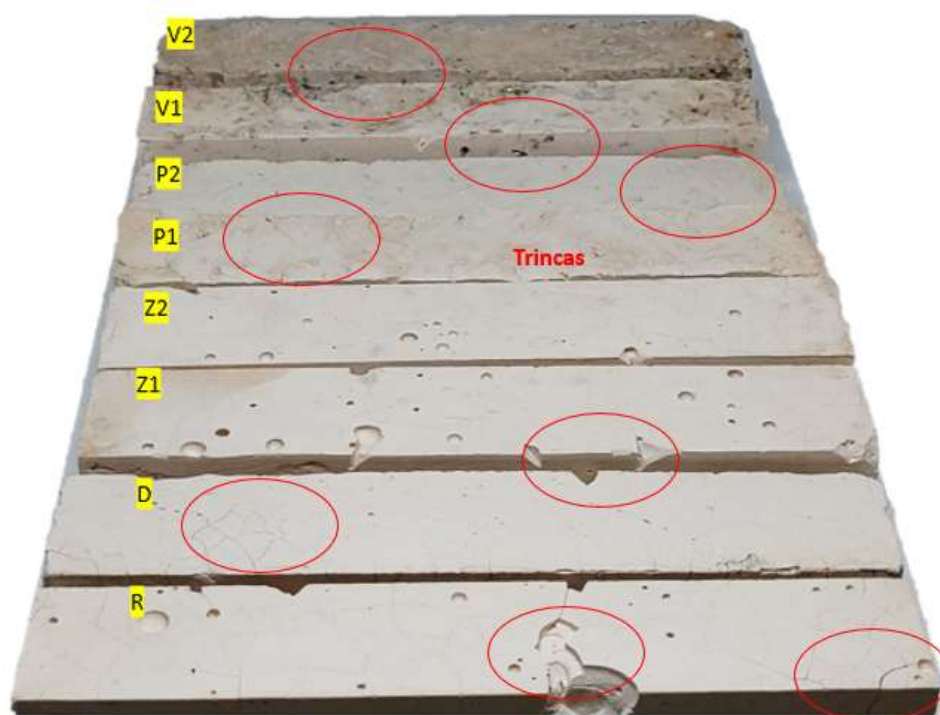
Figura 5.29 – Amostras dos concretos após finalização do ensaio de envelhecimento acelerado por imersão e secagem.
