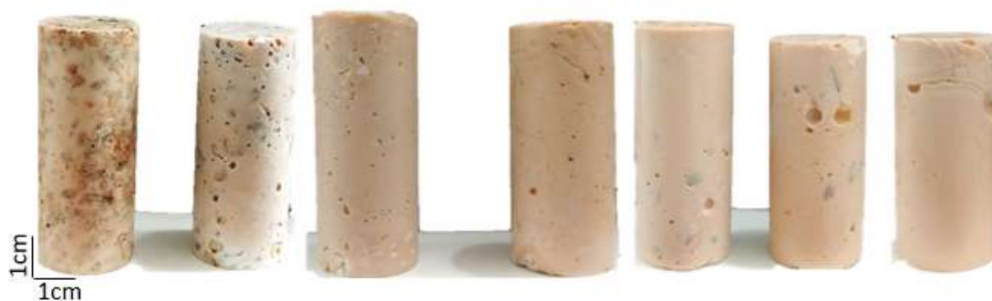
Figura 4.2 – Exemplos de amostras cilíndricas dos concretos geopoliméricos, sequencialmente: V 2 , V 1 , P 2 , P 1 , Z 2 , Z 1 e D.
