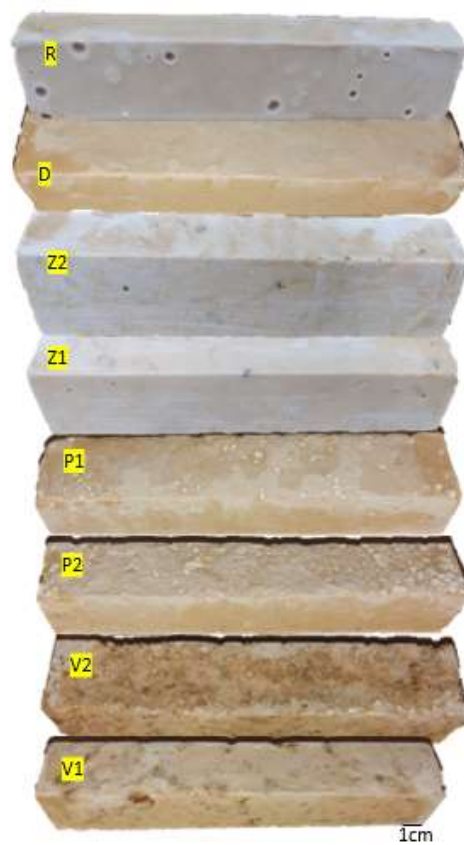
Figura 5.30 - Amostras dos concretos antes do ensaio de envelhecimento acelerado por UV.
