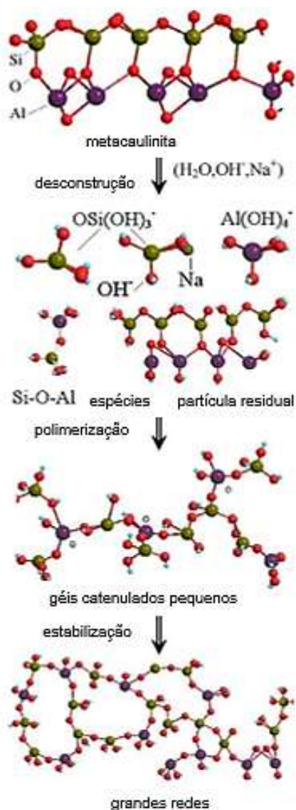
Figura 3.2 – Esboço esquemático do processo de geopolimerização [22].
