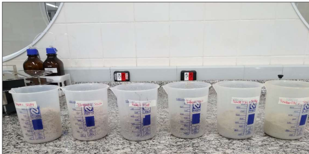
Figura 4.2 – Preparo das biomassas secas e trituradas para a etapa de pré-hidrólise alcalina
