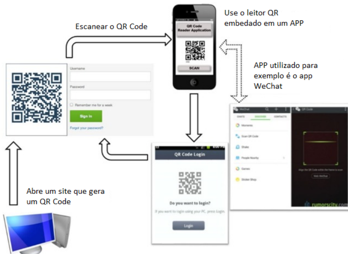
Figura 1 - Funcionamento de um login via QR Code (adaptado de YANG,ZHANG,LANTING, 2016)
