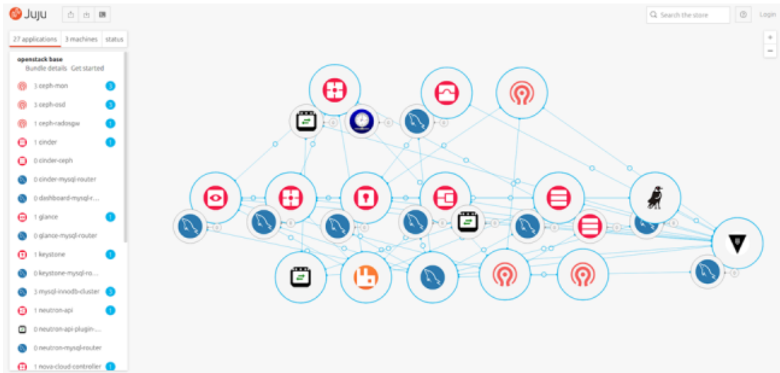
Figura 22 – Configuração final da instalação do OpenStack.
