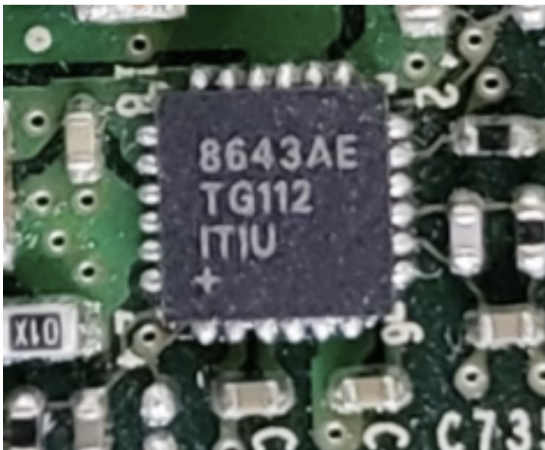
(a) Chip 8643AE, que atua como conversor DC-DC na placa.
