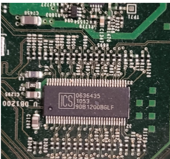
(a) Chip modelo ICS 9DB1200BGLF, que atua como dispositivo de buffer diferencial.
