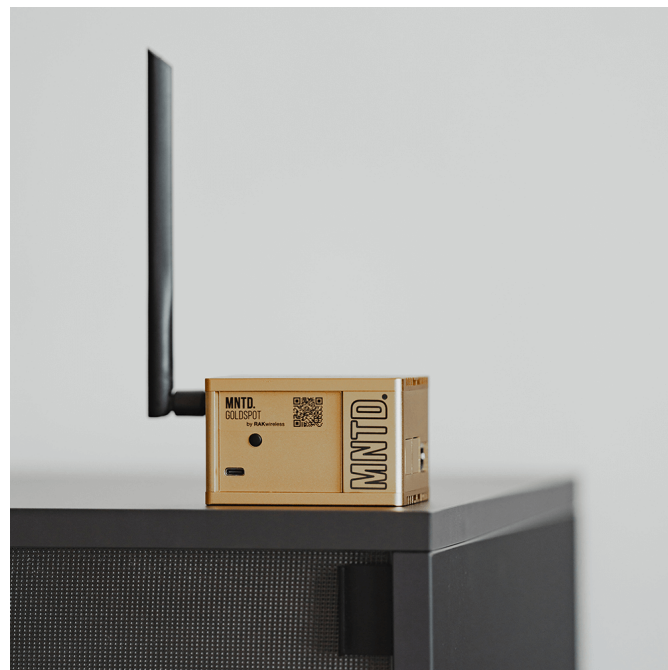
Figura 2: gateway MNTD. Goldspot Miner, da RAKwireless, compatível com a rede da Helium Network [15]
