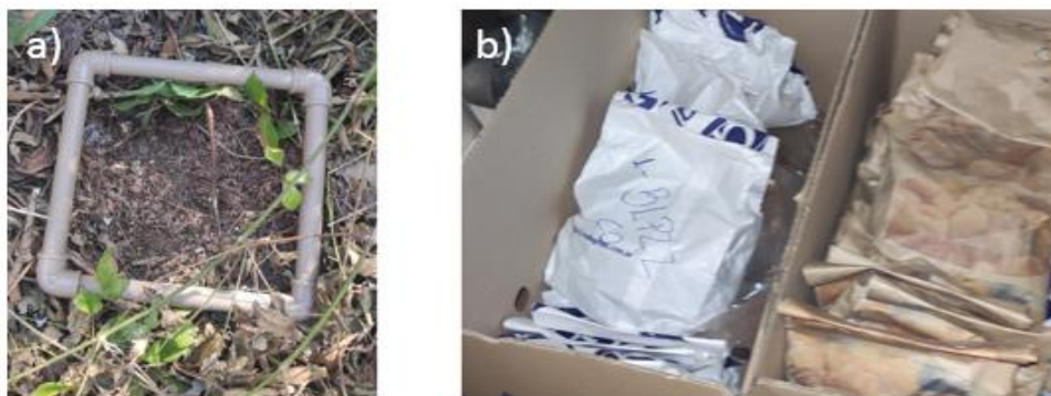
Figura 7. Material utilizado na coleta de serapilheira: a) quadrado de PVC utilizado para amostragem de serrapilheira; b) sacos de papel com o material já acondicionado antes da condução à estufa para estabilização e obtenção da massa seca.
