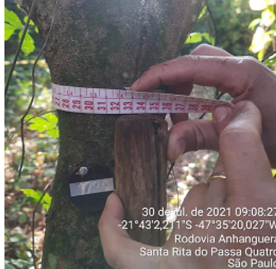
Figura 6. Mensuração do CAP de indivíduo arbóreo com CAP \geq 15 cm existente em parcela.
