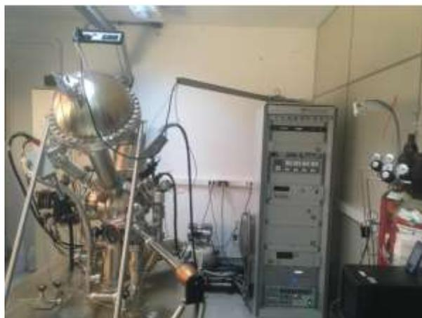
Figura 4-6 Equipamento de XPS instalado no IFSC/USP.
