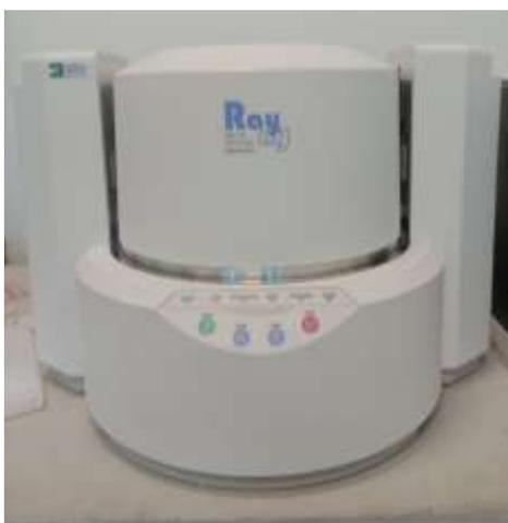
Figura 4-3 FRX Shimadzu 720, instalado no IFMS.
