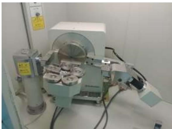
Figura 4-4 Difratorômetro de raios X instalado no IFMS
