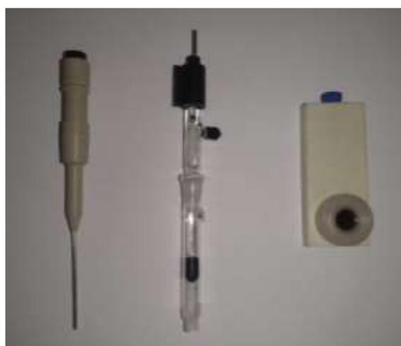
Figura 4-12 Contra eletrodo de platina, Eletrodo de referência saturado de calomelano saturado e um porto eletrodo de trabalho, respectivamente.
