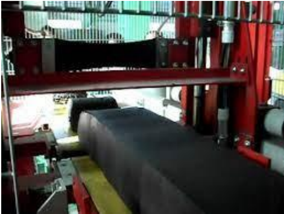
Figura 3 - Processo de extrusão de massa de tamponamento (JC Steele & Sons, 2011)
