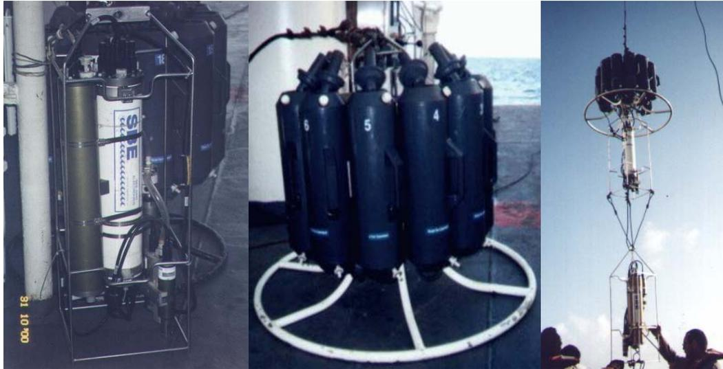
FIGURA 10 - CTD, rosseti e montagem dos dois, respectivamente, usados nas coletas, a bordo do Noc. ANTARES
