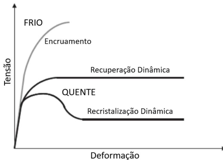
Figura 1: Fenômenos relacionados à deformação em diferentes condições de temperatura e suas contribuições para a alteração da resistência mecânica. Adaptado de (GUO-ZHENG, 2013).
