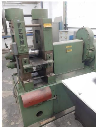
*Figura 5: Laminador FENN com rolos cilíndricos de 13,37 cm de diâmetro e velocidade de rotação de 52 rpm utilizado para a laminação das amostras tratadas termicamente a T1, T2 e T3.*
