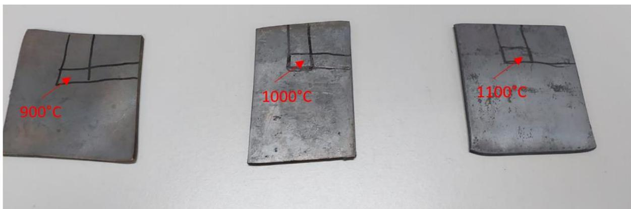
*Figura 6: Região escolhida para amostragem das chapas laminadas nas 3 condições ( $T_1 = 900^\circ\text{C}$ ,  $T_2 = 1000^\circ\text{C}$ ,  $T_3 = 1100^\circ\text{C}$ ) indicadas pelas setas vermelhas.*
