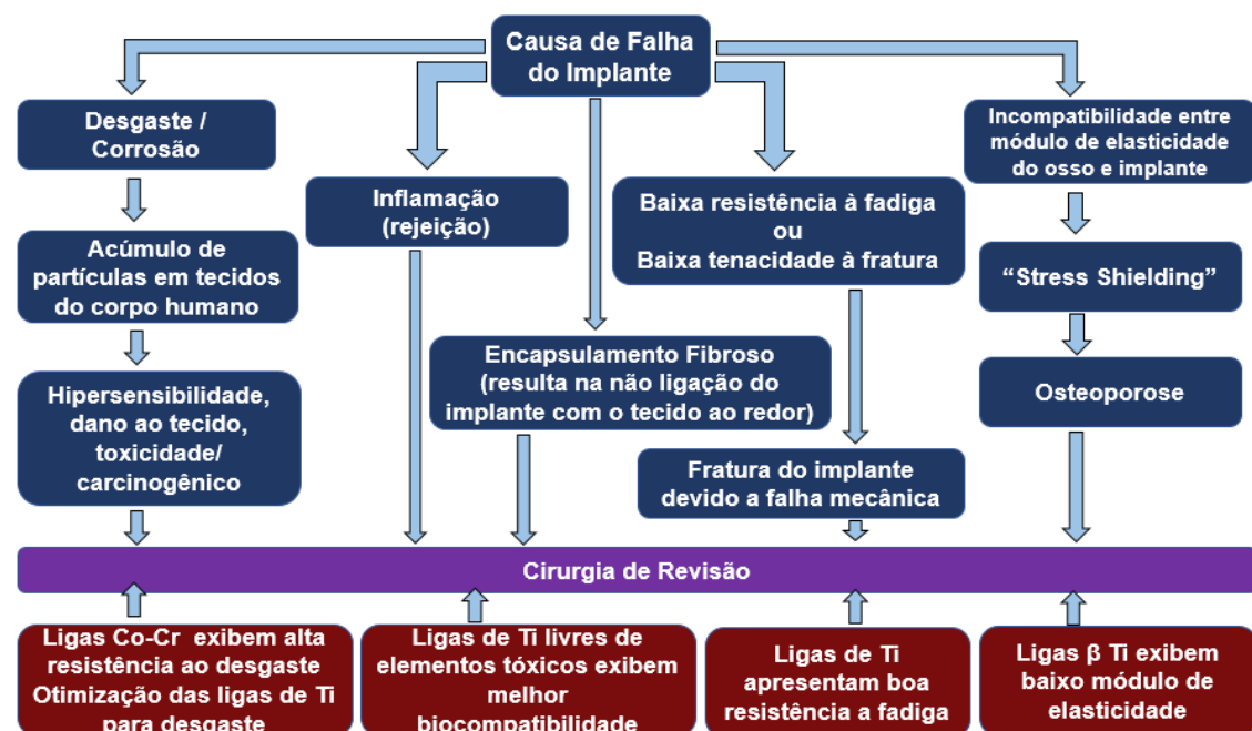
Figura 1.2 – Causas de falhas que acarretam em cirurgias de revisão e algumas abordagens de soluções para melhoria dos implantes (adaptado de [15]).
