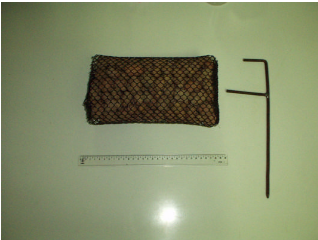
Figura 9 - Substrato artificial e fixador de fundo utilizados para amostragem dos macroinvertebrados bentônicos.
