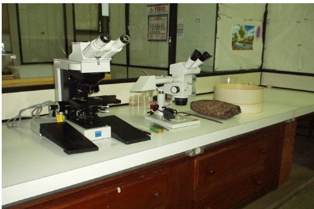
Figura 11 – Materiais utilizados na pesquisa – Microscópio binocular com platina móvel (Marca Askania/Zeiss), Lupa estereoscópica c/ acessório de câmara clara (Marca Askania/Zeiss), Substrato e Peneira de lavagem.
