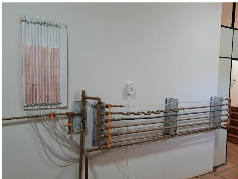
Figura 2 - Registros, manômetro, piezômetros, tubulações estudadas e interruptor da motobomba
