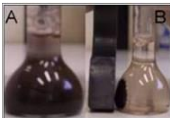
Figura 2. A) Exemplo de Nanopartículas sintetizadas em solução aquosa e B) sua atração pelo ímã. Ref.:(LAVAYEN, 2021).
