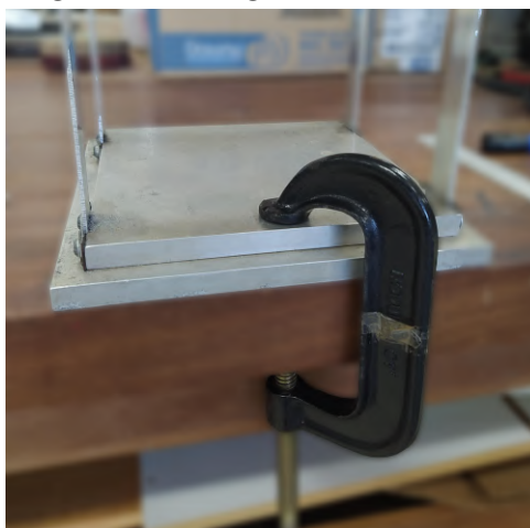
Figura 16 – Engaste da estrutura.
