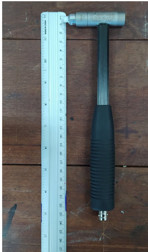
Figura 14 – Martelo de Impacto usado nos testes.
