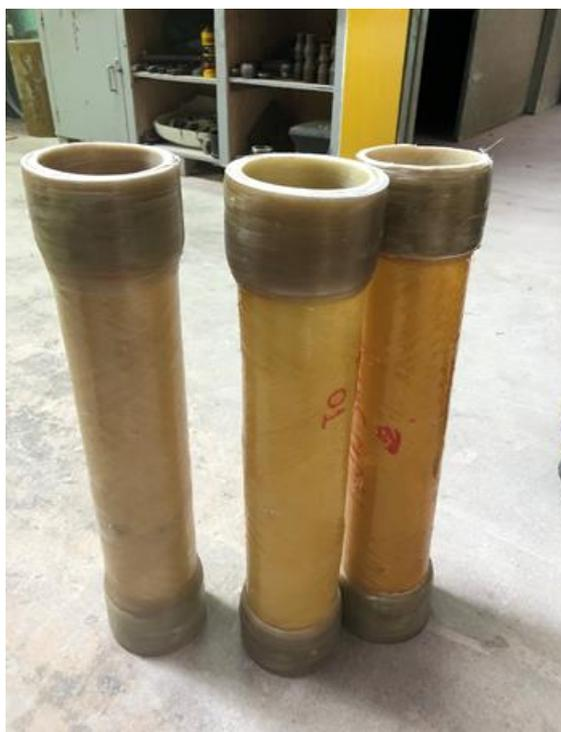
Figura 4.21: Tubos preparados para teste de resistência à ruptura.
