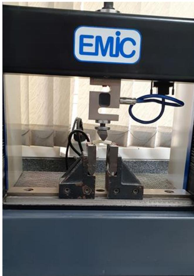
Figura 3.9: Exemplo de execução de ensaio de resistência ao cisalhamento
