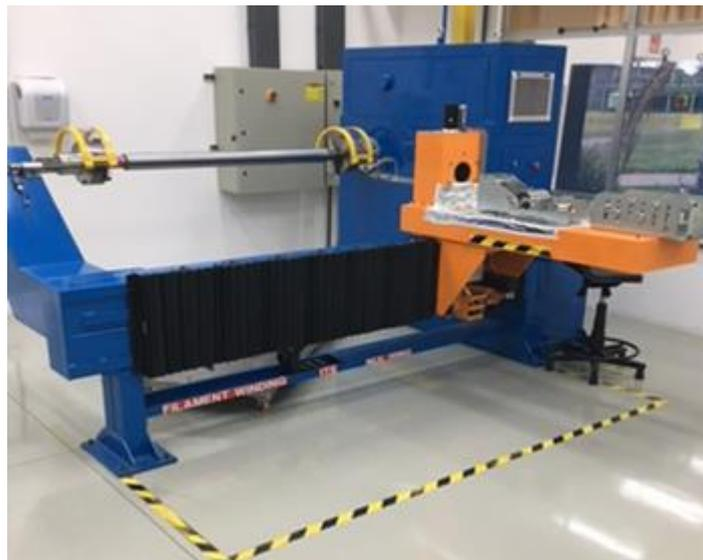
Figura 3.10: Equipamento para processo de enrolamento filamental
