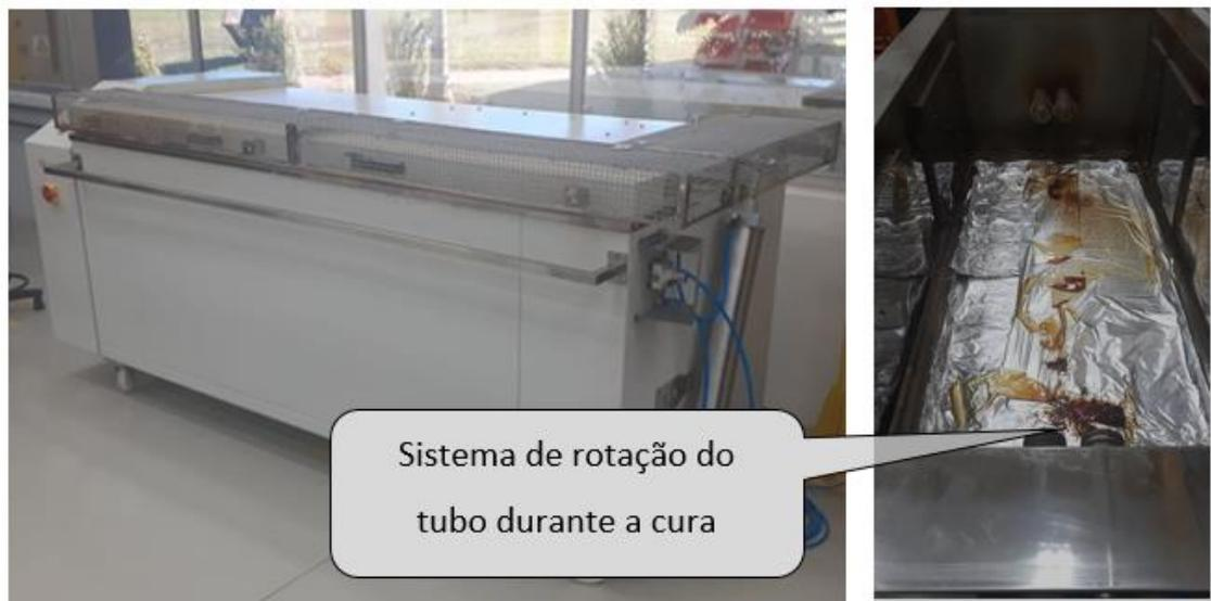
Figura 3.12: Estufa para cura dos tubos compósitos
