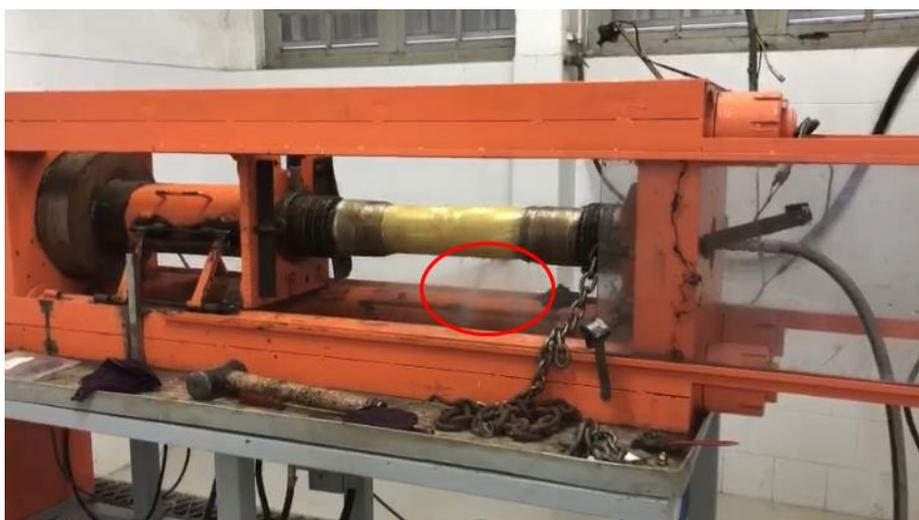
Figura 4.22: Vazamento típico durante o teste de ruptura.
