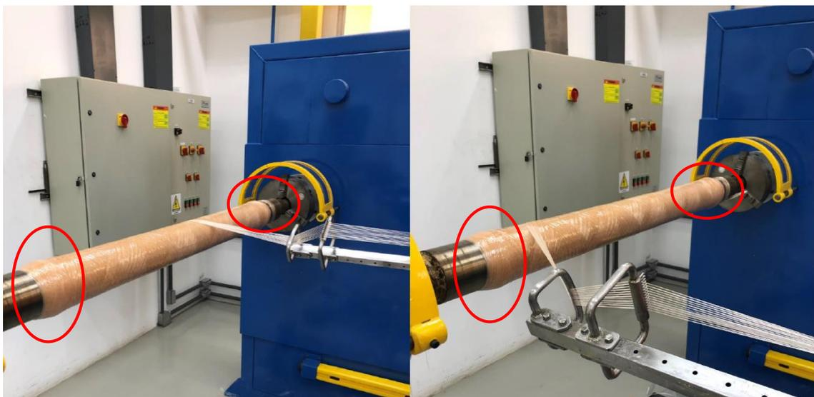
Figura 3.11: Detalhe de dois momentos distintos do processo de enrolamento filamental helicoidal para a produção dos tubos compósitos
