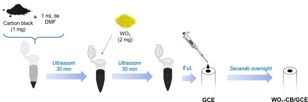
FIGURA 3.6 - Esquema de fabricação do composto e sensor de WO 3 -CB/GCE. Fonte: autoria própria.
