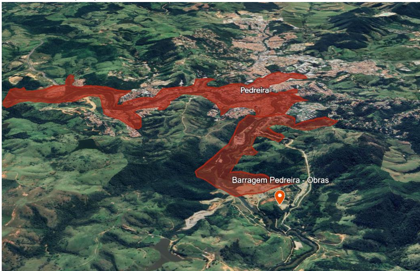
Figura 60 - Proximidade da barragem de Pedreira da área urbanizada da cidade e zonas de autossalvamento (ZAS).
