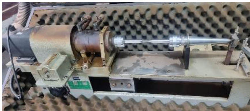
Figura 45 –Máquina de fadiga por flexão rotativa da marca Fatigue Dynamics Inc. modelo RBF 200.
