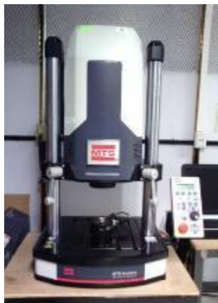
Figura 43 –Máquina de ensaio de fadiga de contato eletrodinâmica na marca MTS Acumen 1500N pertencente ao laboratório do grupo de engenharia de superfície do IPN Azcapotzalco-México.
