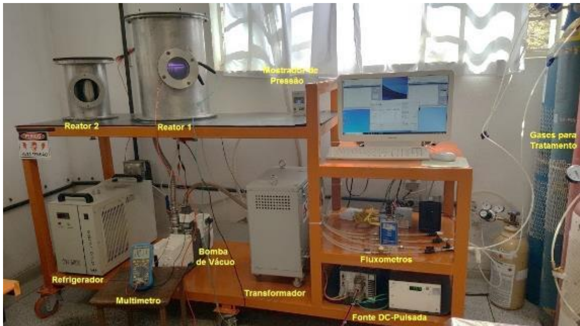
Figura 39 –Equipamento de nitretação a plasma do LABTES da FATEC Sorocaba utilizado nesse trabalho.
