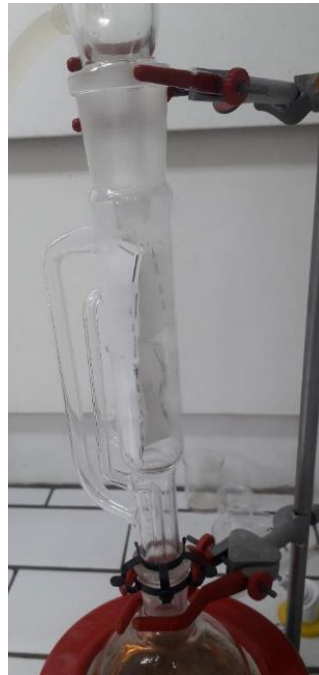
FIGURA 3.2. Sistema de silanização em extrator de Soxhlet da argila sepiolita.
