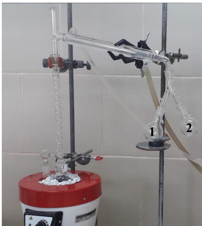
FIGURA 2.5. Sistema para destilação e purificação da anilina comercial.
