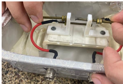
FIGURA 2.8. Imagem da cela para medida de resistência.
