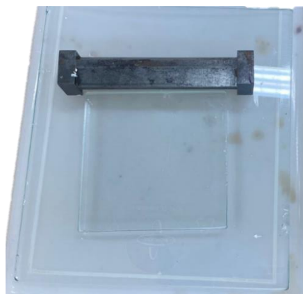
FIGURA 2.7. Extensômetro utilizado para obtenção das membranas de PES e PES.Pani ajustado em 150 \mu\text{m} .
