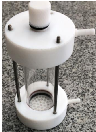
FIGURA 3.3. Cella utilizada para análise de fluxo de água.
