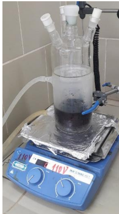
FIGURA 2.6. Reator encamisado para banho termostaticado, sistema de obtenção do sal de esmeraldina.
