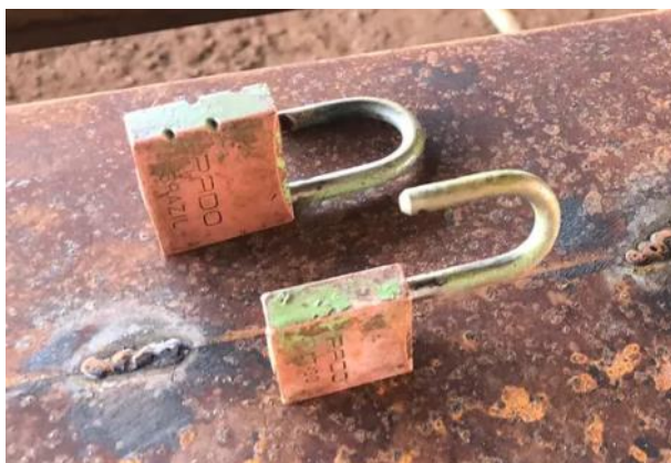
Figura 7 Corrosão em cadeados causada pela névoa tóxica.
