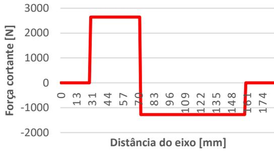
(a) Força cortante no plano XY no Eixo 3
