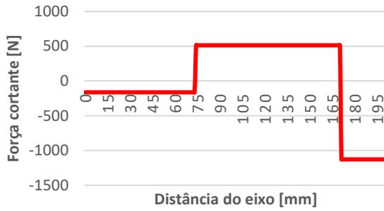
(a) Força cortante no plano XY no Eixo 1
