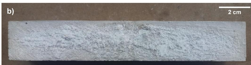
Figura 4.3: Características estruturais desenvolvidas pelas matrizes após cura à 40°C/24h. (a) Evolução do módulo ao longo de 16 dias de análise. (b) Cristais de eflorescência na superfície de uma amostra da composição AT-3CAC-9CG.
