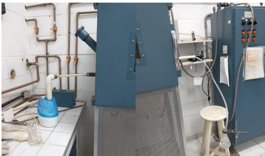
Figura 7 – Primeira versão do sistema de spray pirólise assistida por micro-ondas
