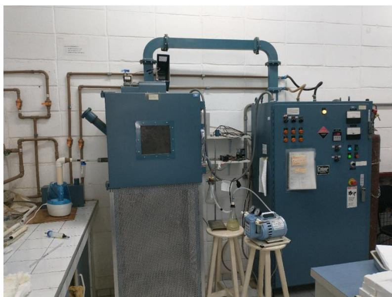
Figura 9 – Sistema de deposição completo
