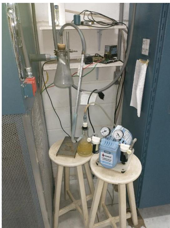
Figura 8 – Sistema de filtragem e coleta de partículas
