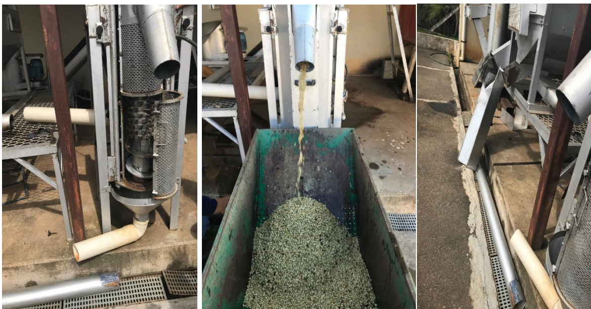
FIGURA 3.1: Imagens do equipamento utilizado no despulpamento e desmucilagem do café no IFSULDEMINAS – Campus Muzambinho.
