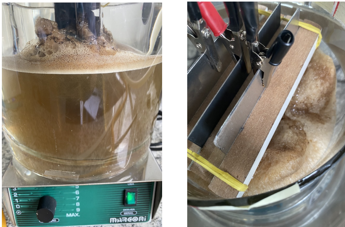
FIGURA 4.2: Imagens de uma amostra de ARC (pH = 4,67) submetida ao tratamento por eletrólise com uma densidade de corrente de 20 \text{ mA cm}^{-2} .
