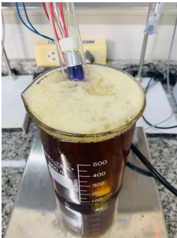
FIGURA 4.10: Imagem ilustrando o aparato empregado para o tratamento de amostras de ARC usando o processo foto-Fered-Fenton.
