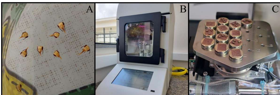
Figura 1. Preparo de S. postica para MEV. (A) Cabeças dissecadas. (B) Dispositivo de revestimento à vácuo. (C) Stubs com amostras metalizadas inseridas no porta amostras.
