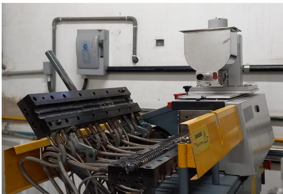
Figura 3.1 - Extrusora dupla rosca co-rotacional B&P MP-2019 utilizada na preparação das misturas poliméricas
