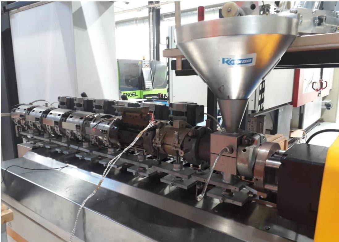
Figura 3.7 - Extrusora dupla rosca modular co-rotacional Collin ZK 25P e seu alimentador gravimétrico K-Tron
