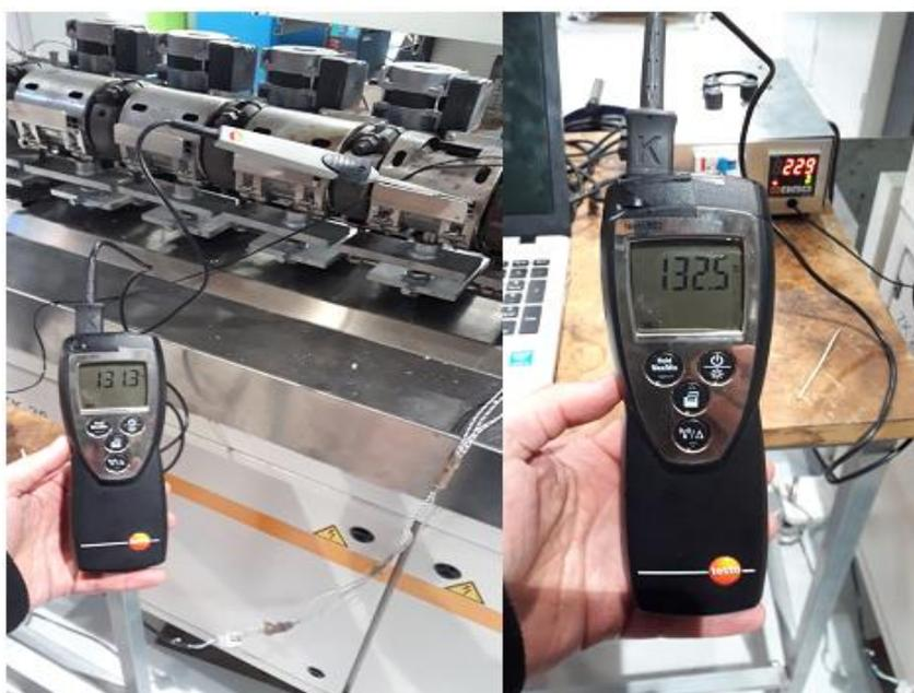
Figura 4.27 - Termômetro digital do tipo espeto usado nas leituras de temperatura do polímero em fluxo
