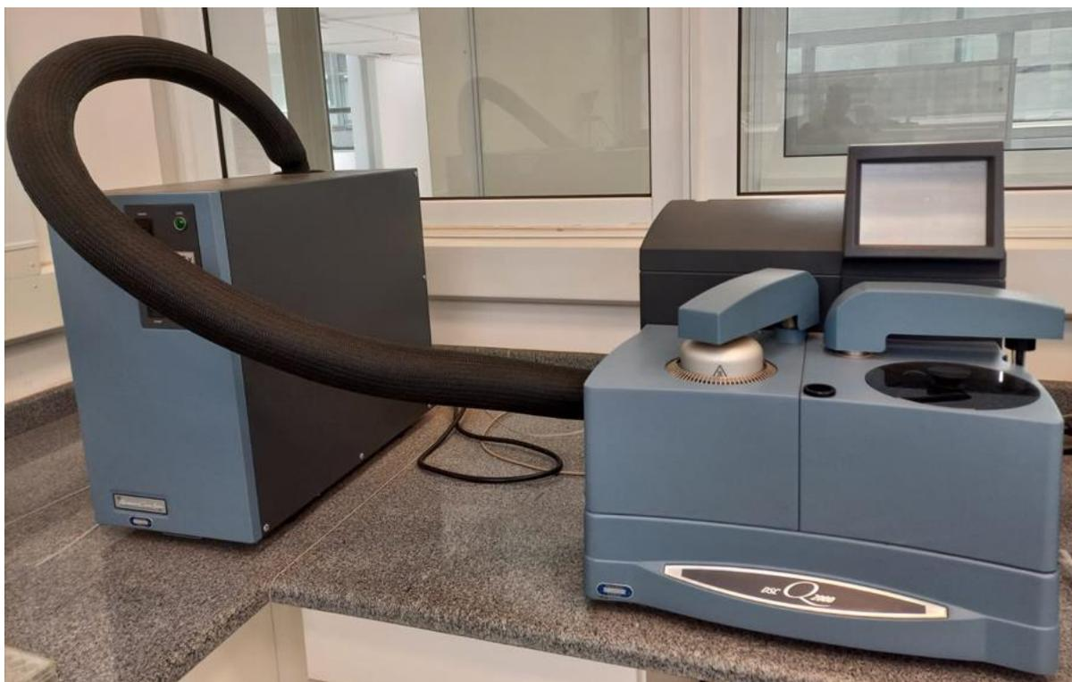
Figura 3.3 - DSC Q2000 da TA Instruments
