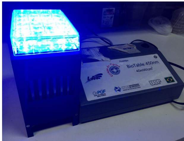
Figura 8. Equipamento de luz chamado Biotable, desenvolvido pelo Laboratório de Apoio Tecnológico da USP (LAT – USP), emitindo luz em comprimento de onda equivalente a luz azul ( \lambda=450 nm). Fonte: Elaborado pela autora, 2023.
