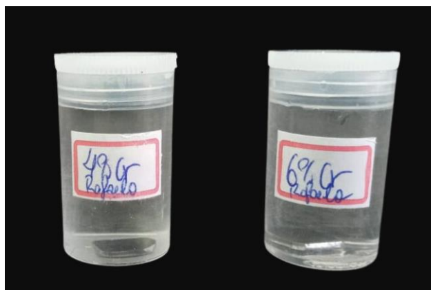
Figura 4.8 – Amostras preparadas nas dimensões requisitadas no ensaio e em recipientes selados para evitar contaminação do filme passivo.
