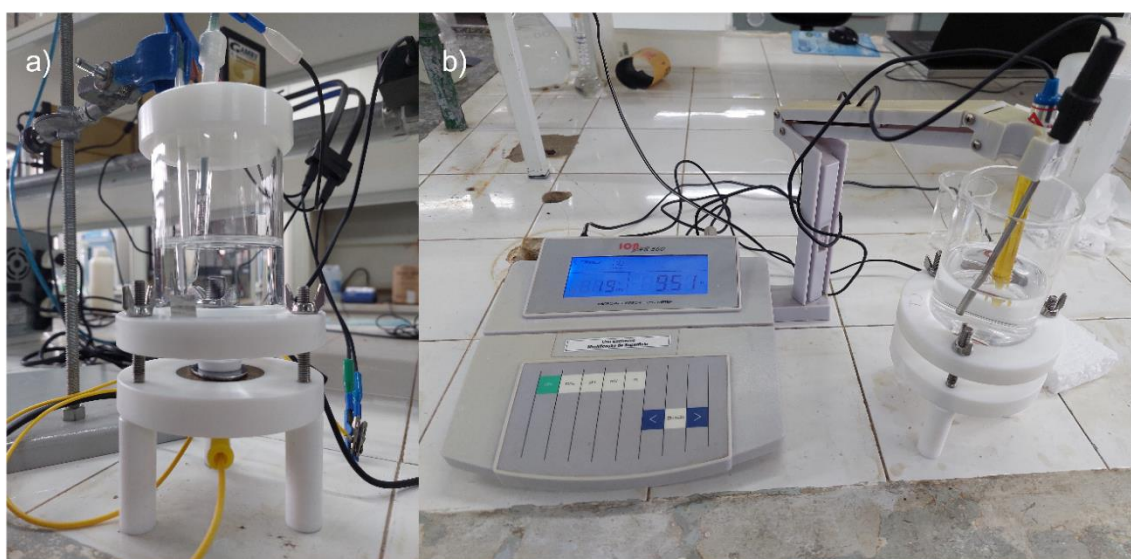
Figura 4.5 – a) Célula eletroquímica real, com a solução carbonatada sintética e amostra da liga produzida, que funcionam como eletrólito e eletrodo de trabalho, respectivamente. b) pHmetro de bancada com aferição do pH da solução imediatamente após a conclusão do ensaio eletroquímico.
