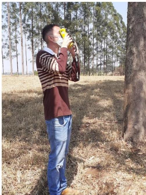
**Figura 9.** Medição de altura de árvore de eucalipto na área de estudo utilizando o hipsômetro.
