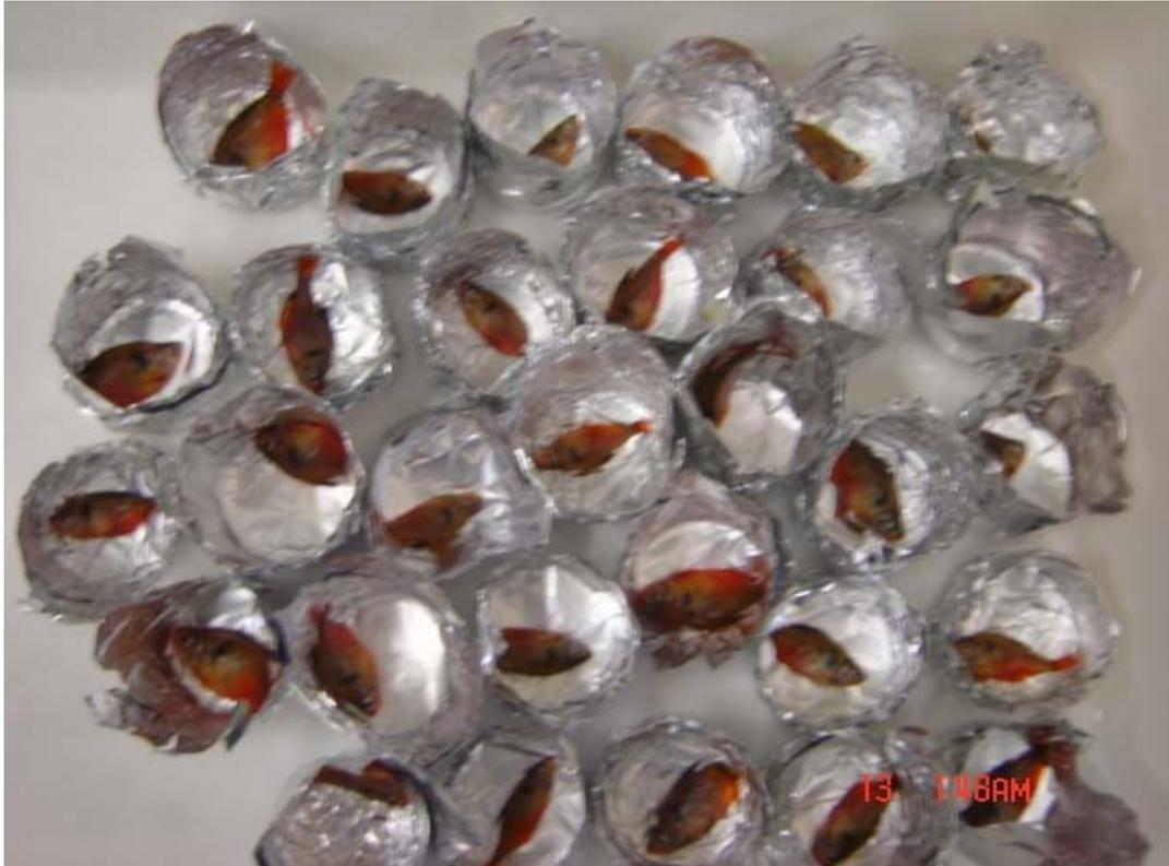
Figura 7 – Vista geral dos peixes já medidos e transferidos para cadinhos de papel alumínio para secagem em estufa visando a obtenção do peso seco.
