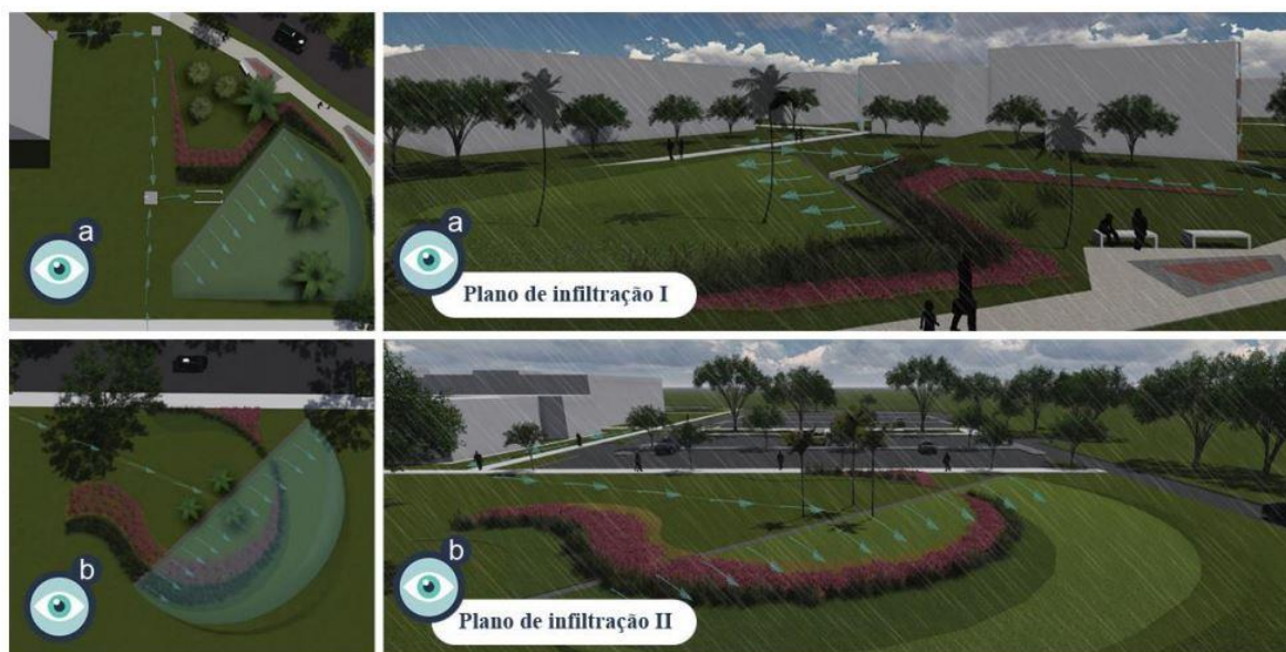
Figura 9 – Sistema Filtro–Vala–Trincheira de infiltração construído no campus da Universidade Federal de São Carlos - UFSCar
