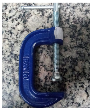
Figura 15. Sargento utilizado para fixação da fibra na mesa de corte. Fonte: Autoria própria.
