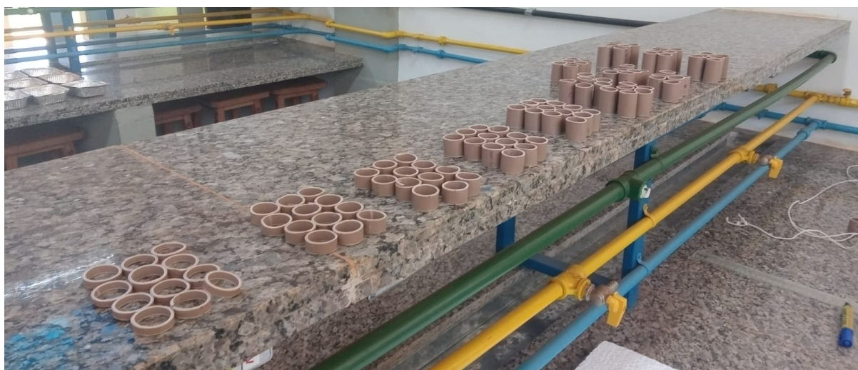
Figura 11. Moldes de PVC. Fonte: Autoria própria.
