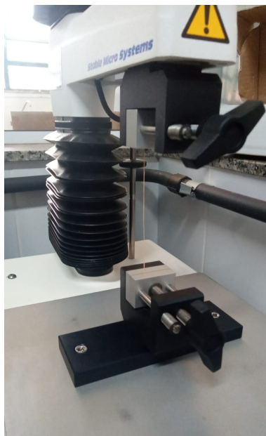
Figura 14. Teste de ruptura em execução. Fonte: Autoria Própria.
